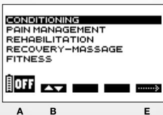
**A** Нажмите на кнопку включения, чтобы отключить прибор.
