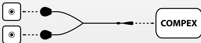
N.B. El cable de Mi-sensor (si el dispositivo lo incluye) se puede conectar en cualquier salida de cables del estimulador.
