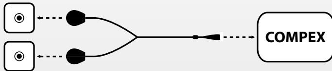
N.B. : Le câble MI-sensor (si disponible avec l'appareil) peut se connecter sur n'importe quelle prise du stimulateur
